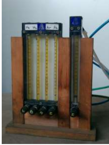
Şekil 4.5 : Standart akış ölçerler (sırasıyla soldan sağa: He, H 2 , Ar, N 2 , BCl 3 ).
