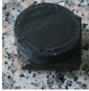
Şekil 3.3 : Üzerine pasta borlama ajanı sürülmüş numune.
