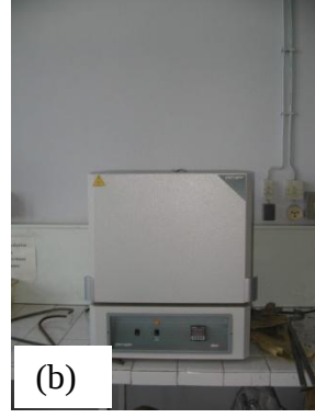
Şekil 5.1 a) Deneylerde kullanılan paslanmaz çelik kutu b) Borlama işleminde kullanılan elektrik dirençli fırın.
