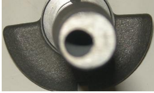
Şekil 4.10 : Krank mili giriş deliğinin eksenden kaçırıldığı prototip çalışması
