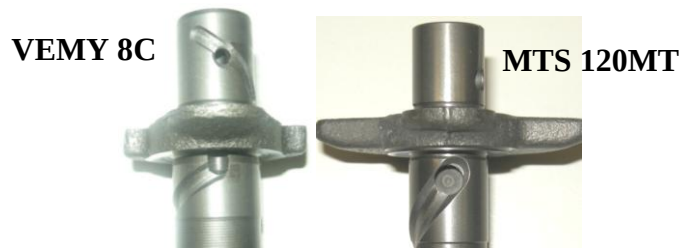
Şekil 4.5 : VEMY 8C ile MTS 120MT model kompresörlerin üst yatak tasarımlarının karşılaştırılması
