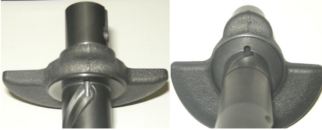
Şekil 4.12 : Üst yatak tasarımının değiştirildiği prototip çalışması (2,5 mm)
