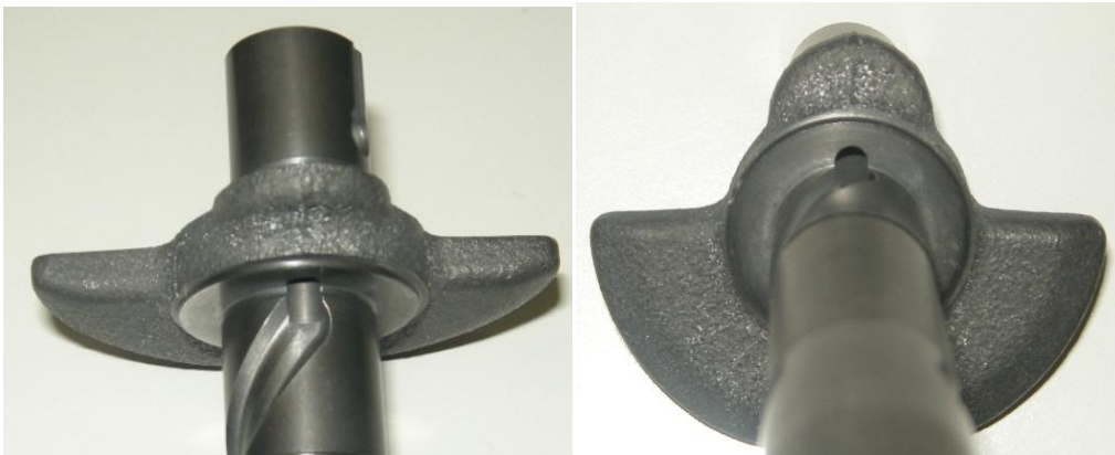
Şekil 4.13 : Üst Yatak tasarımının değiştirildiği prototip çalışması (3,5 mm)
