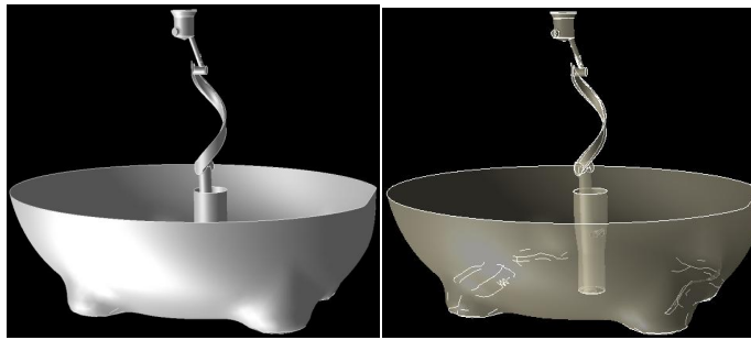
Şekil 6.6 Kompresörde yağlama sisteminin CAD çizim modeli [24]
