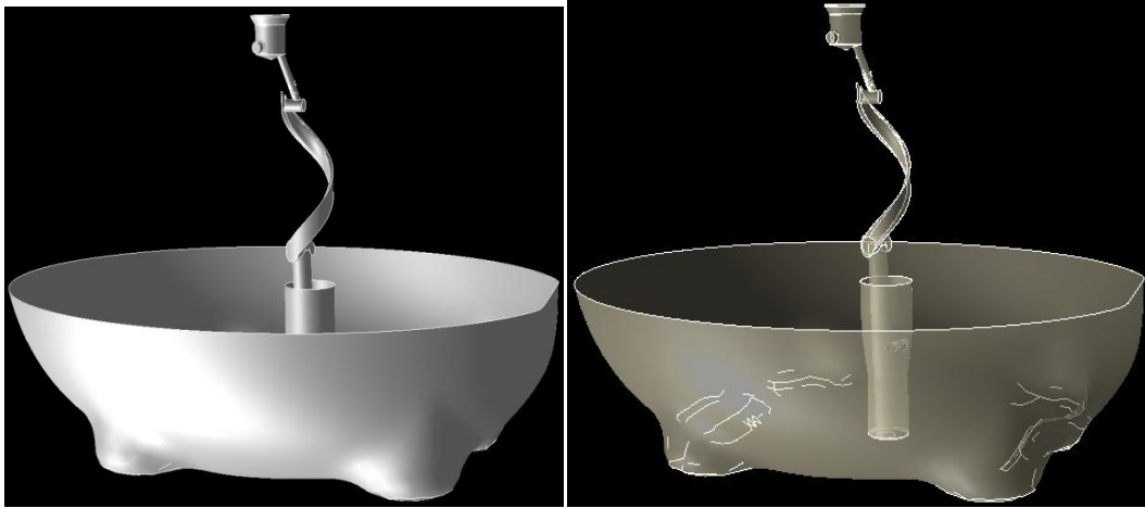
Şekil 5.1 : Kompresörde yağlama sisteminin CAD çizim modeli [24]
