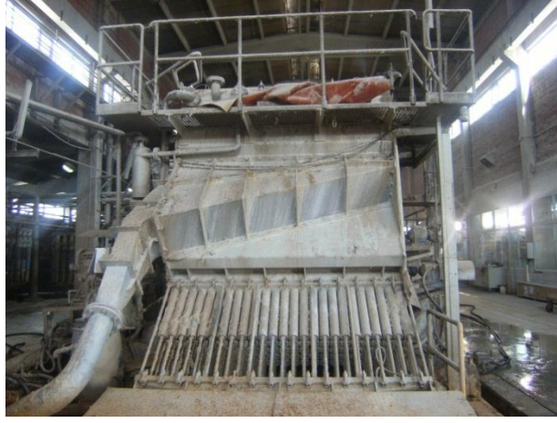
Şekil 4.6 : KM2 hidrolik hamur kasası.
