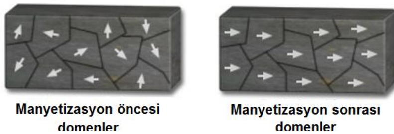
Şekil 3.4: Ferromanyetik bir malzemede manyetizasyon öncesi ve sonrası domenlerin manyetik moment yönleri [78].
