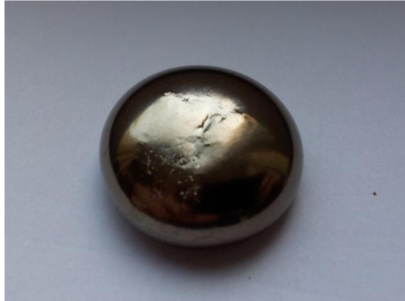
Şekil 5.24: Deney 11’de üçüncü ergitme sonrası gözlenen parlak numune.
