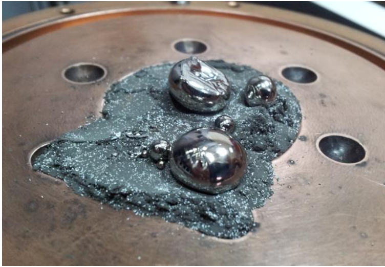
Şekil 5.16: Deney 6'da malzemenin kalıba yerleştirilmesi.
