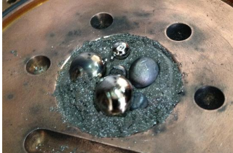
Şekil 5.12: Deney 3’de malzemenin kalıba yerleştirilmesi.
