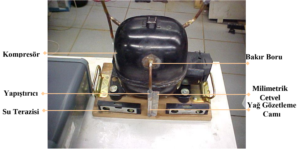
Şekil 4.7 : Yağ dönüş deneyinde kullanılan kompresör
