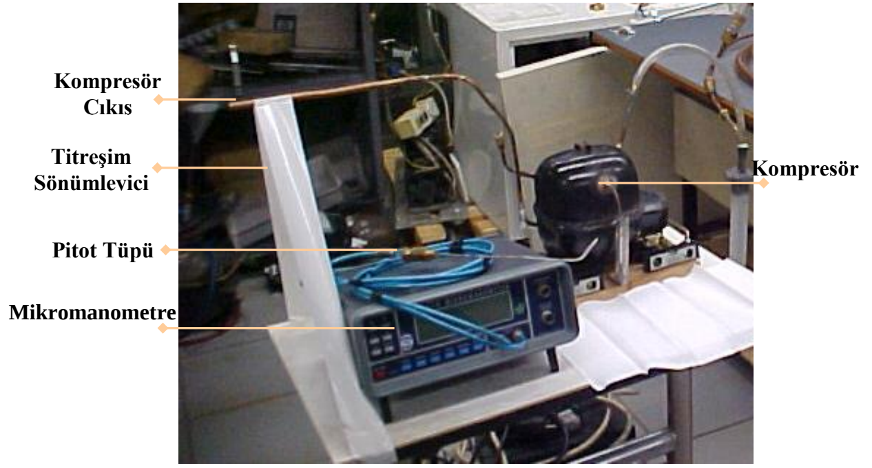
Şekil 4.16 : Kompresör çıkışından hız ölçümü
