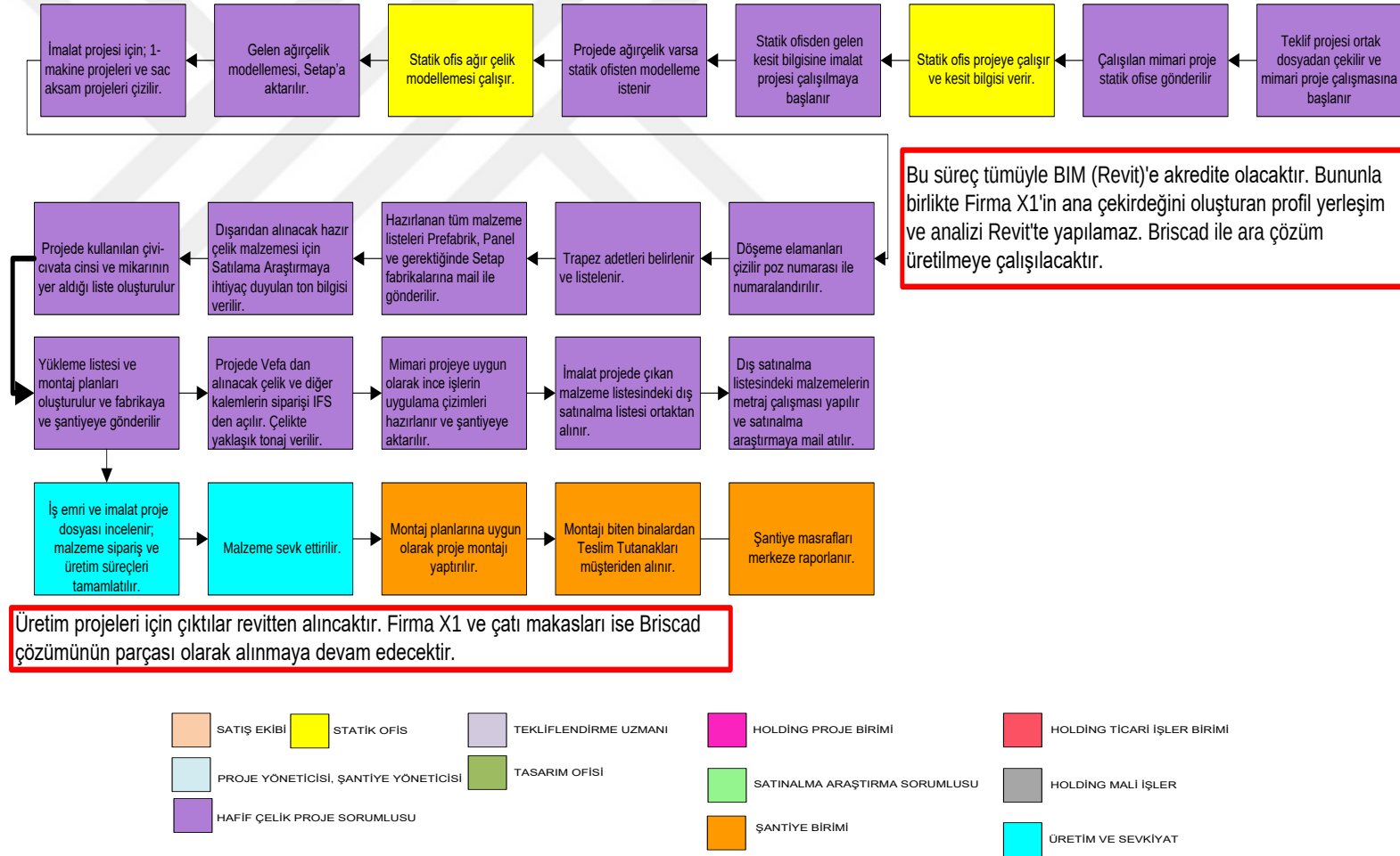
Şekil 5.17: BIM'den sonra statik proje kontrolü ve montaj süreci.
