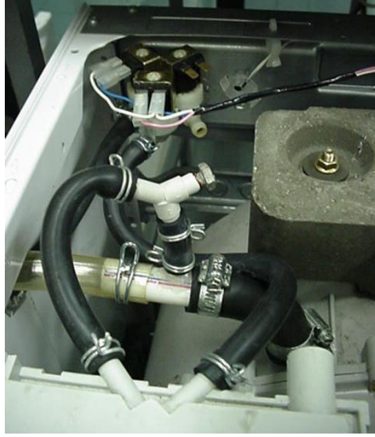
Şekil 5.13: Çamaşır Makinasında Su Tesisatı
