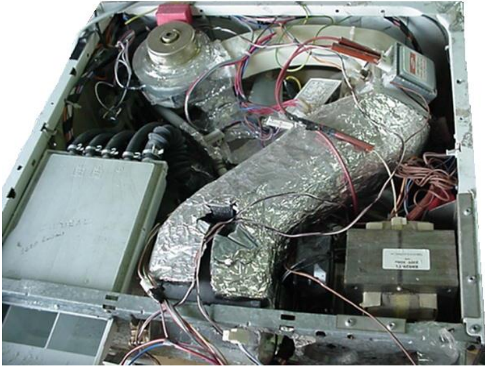
Şekil 5.1: Çamaşır Makinasında Magnetron ve Diğer Bileşenlerin Yerleşimi
