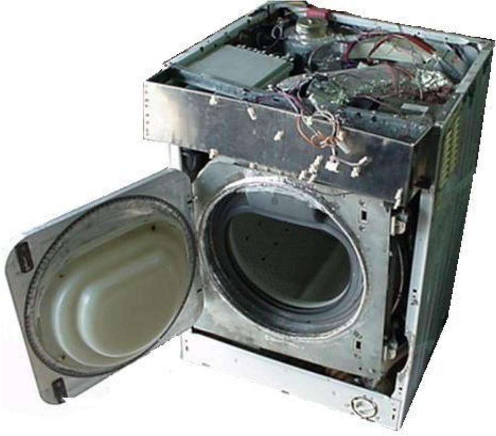
Şekil 5.2: Mikrodalga Destekli Yıkama Yapılan Çamaşır Makinası
