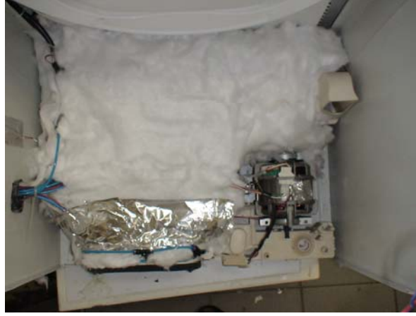
Şekil 3.13 : LUNA Kondenserli kurutucu platformu tambur altı şasinin cam yünü ile yalıtılıp üzerinin bant ile kaplanması üstten görünüşü
