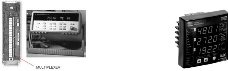
Şekil 3.4 : Datalogger ve multiplexer, enerji analizörü
