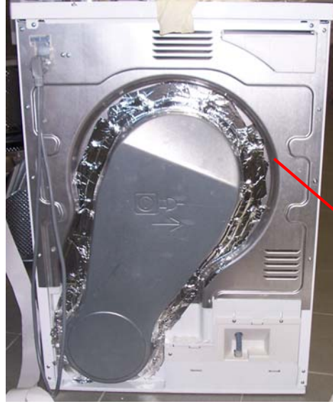
Şekil 3.10 : Isıtıcı etrafının alüminyum folyo ile bantlanması
