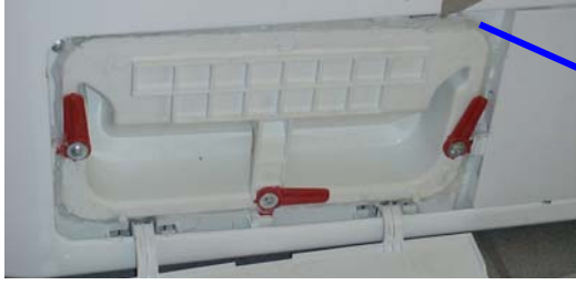
Şekil 3.14 : LUNA Platformu Kondenserli kurutucu için kondenser yalıtımın yapılışı
