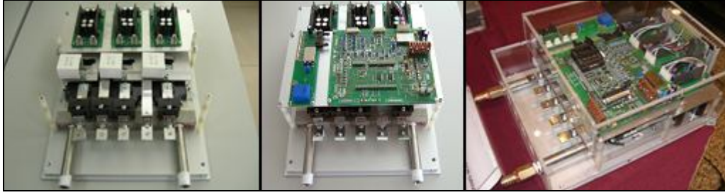
Şekil 5.10: Soğutma Sistemi, IGBT Modülleri, Kartları Monte Edilmiş Elektrik Motor Sürücüsü
