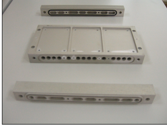
Şekil 7.2: Yeni Soğutma Sistemi-Ön Blok-Orta Blok-Arka Blok
