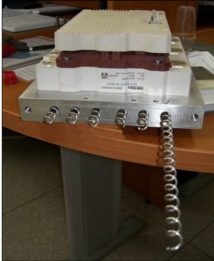
Şekil 3.4: Semikron Soğutma Bloğu-Orta Blok ve Kanal İçerisindeki Yaylar
