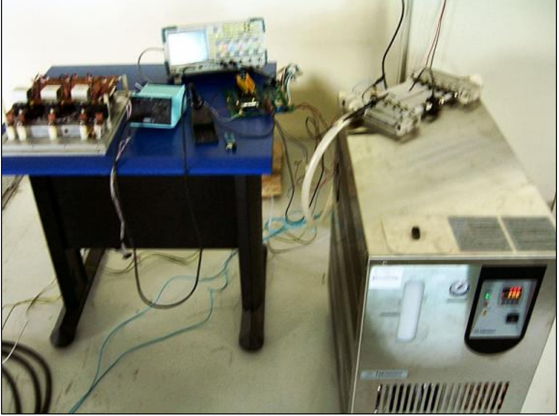
Şekil 4.9: Semikron Soğutma Bloğu Prototipi Test Sistemi
