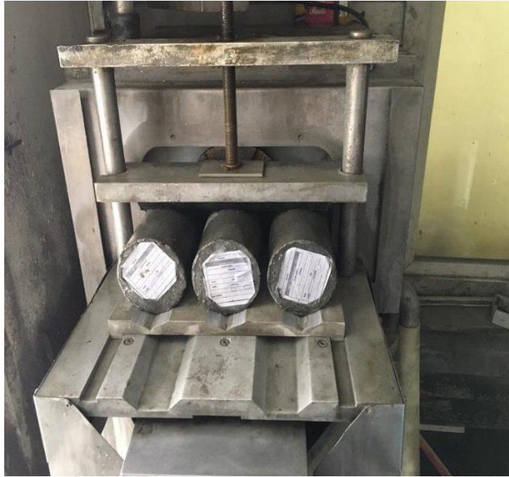
Şekil 4.5 : Beton numunelerin tıraşlama işlemi.
