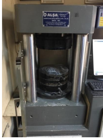
řekil 4.6 : Beton numunelerin basınç dayanım testi.
