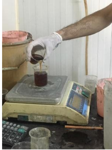
Şekil 4.2 : Beton karışımların hazırlanması.
