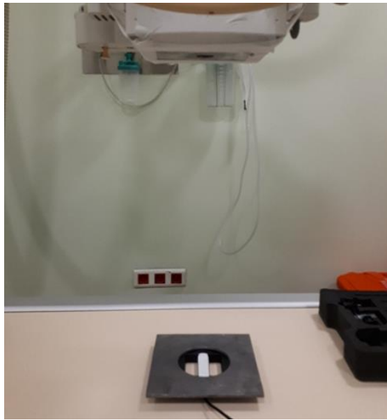
Şekil 4.15 : TS EN 61331-1 Standardına göre oluşturulan geniş demet geometrisi.
