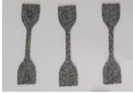
Şekil 4.19 : Esneklik testleri yapılmak üzere hazırlanan numuneler.
