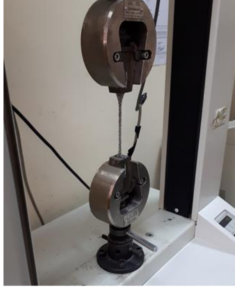
Şekil 4.21 : Esneklik testi sırasında numunenin görünümü.
