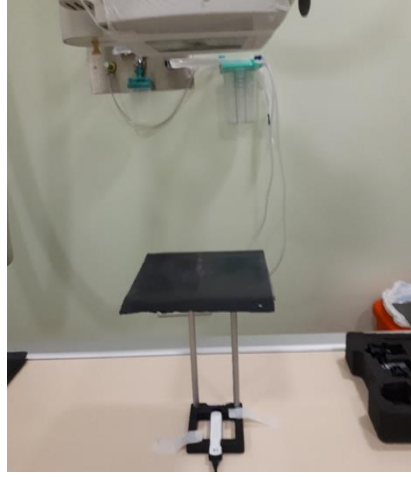
Şekil 4.14 : Dar demet geometrisinde test malzemelerinin konumu.
