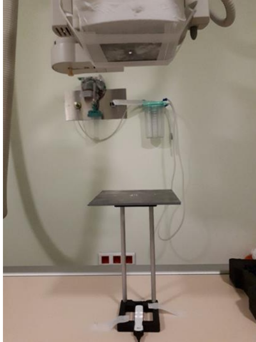
Şekil 4.12 : TS EN 61331-1 standardına göre kurulan dar demet geometrisi.
