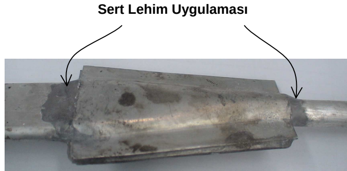
Şekil 3.7: Sert lehimle birleştirilmiş ara parça
