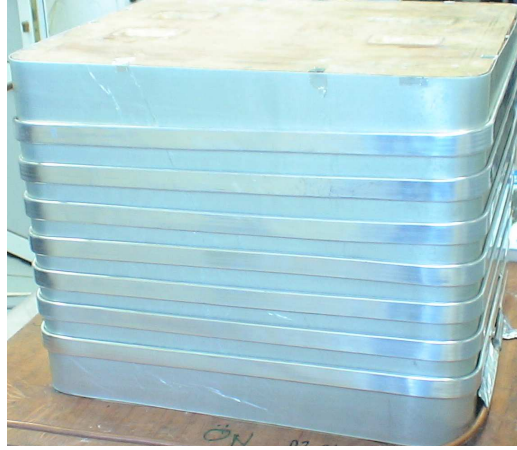
Şekil 3.21: Ahşap maçaya yerleştirilen ve sarımı tamamlanan mikrokanal evaporatör
