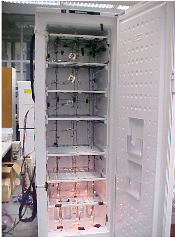
Şekil 4.3: Kabin İç Arka Yüzeyinde Bulunan Thermo-Element Çiftleri
