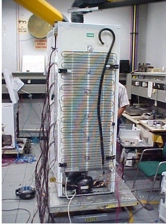
Şekil 4.2: Kabin Dış Arka Yüzeyinde Bulunan Thermo-Element Çiftleri
