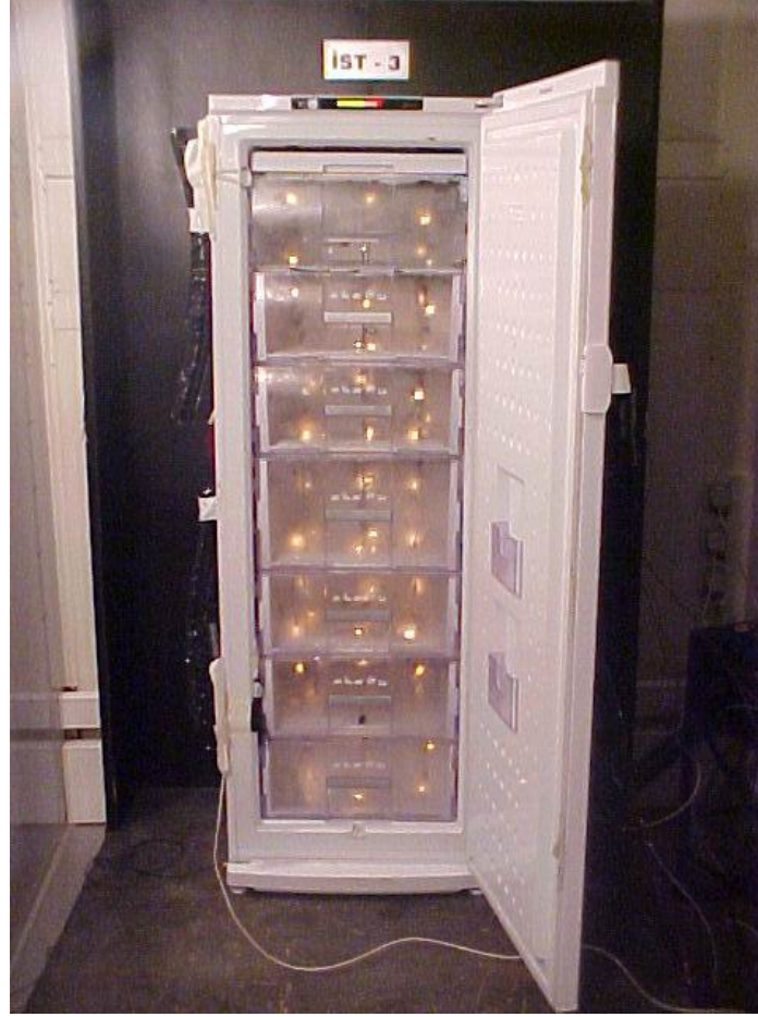
Şekil 4.9: Çekmeceli Halde Lambaların Kabin İçindeki Görünüşü
