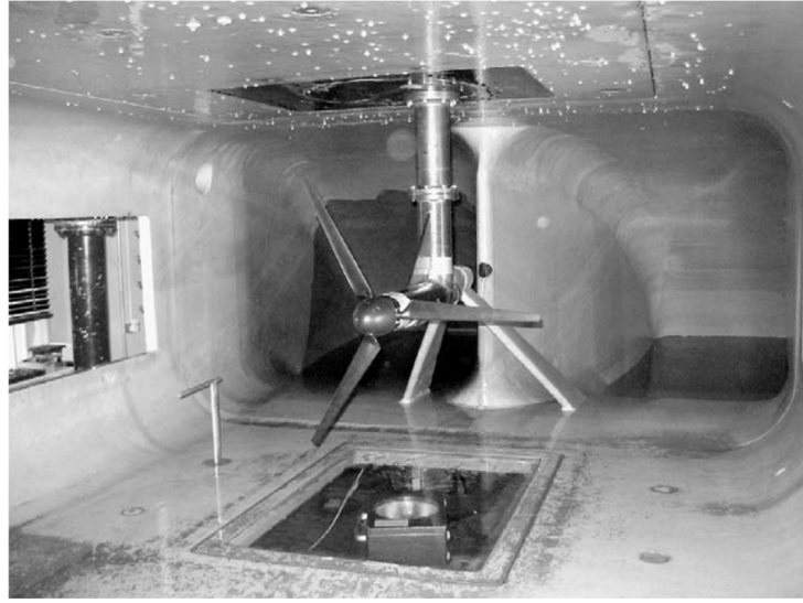
Şekil 2.3 : Su tüneline dinamometreye bağlı prototip türbin [6].
