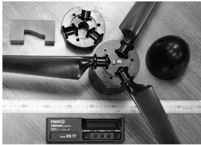
Şekil 2.2 : Makalede kullanılan prototip türbin [6].
