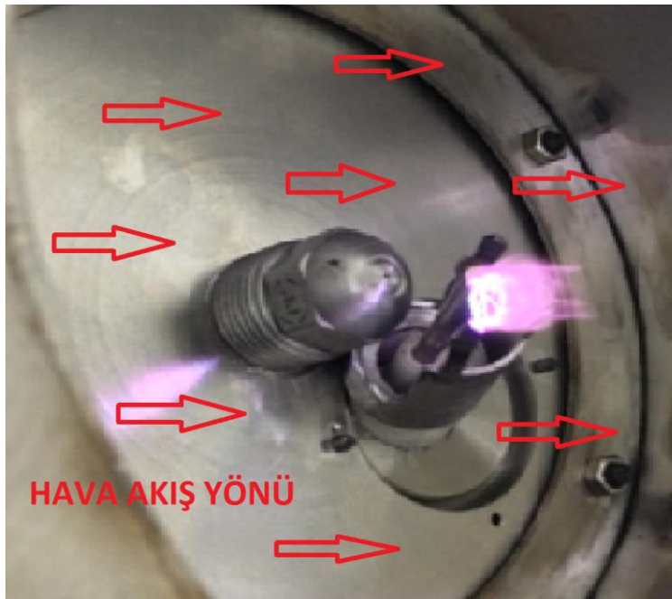
Şekil 3.8 Test sisteminde oluşan yüksek kalitedeki elektrik arkı.
