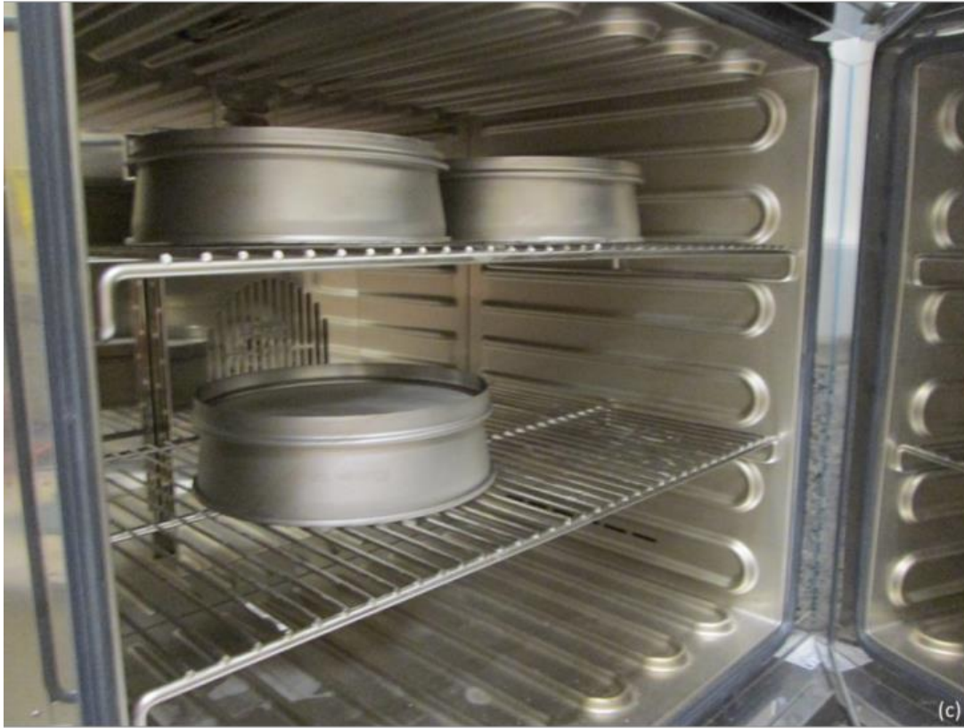
Şekil A.3 : (a) Ultrasonik banyo ve distile su, (b) Fırın, (c) Fırında kurutulan elekler.
