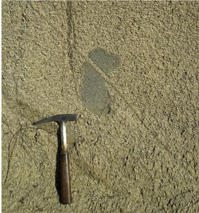
Şekil 2.11 : Anklavı kesen ayrılmış aplit damarı.
