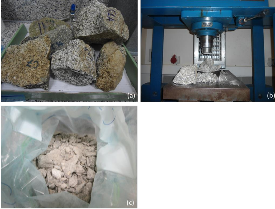
Şekil A.1 : (a) Zirkon analizi için inceleme alanından alınan numuneler, (b) Taş kırma makinesi, (c) Kırılan numune.
