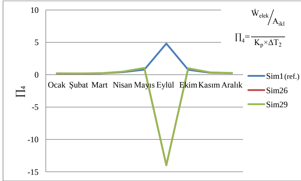
Şekil 4.73 Yerden ısıtma sistemine ısı pompası eklenmesi ile oluşan \Pi_4 boyutsuz sayısı eğrisi ve mevcut diğer iki eğri.
