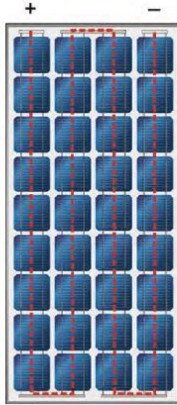
Şekil 2.10 : Standart modülde güneş pillerinin seri bağlanma şekli.
