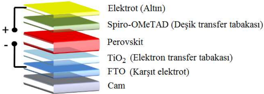
Şekil 2.6 : Perovskit güneş hücresinin yapısı [33].
