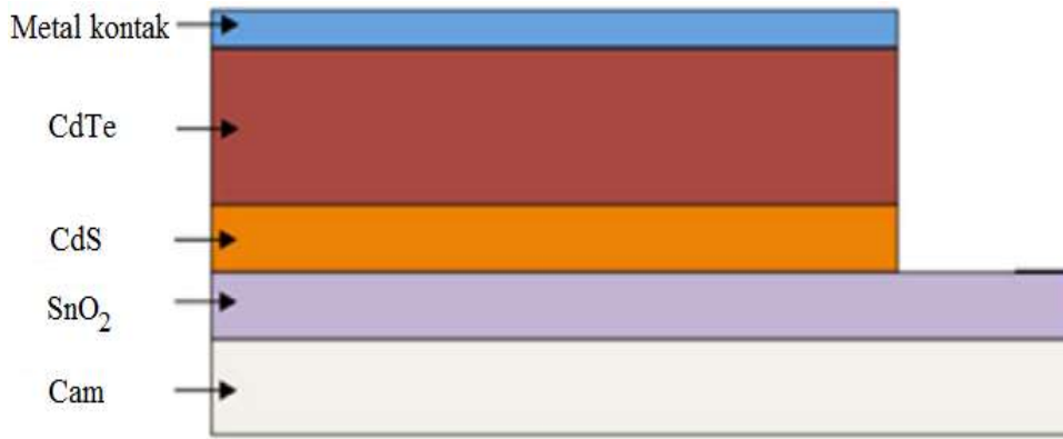
Şekil 2.4 : Tek eklemlili CdTe ince film güneş hücresinin yapısı [16].
