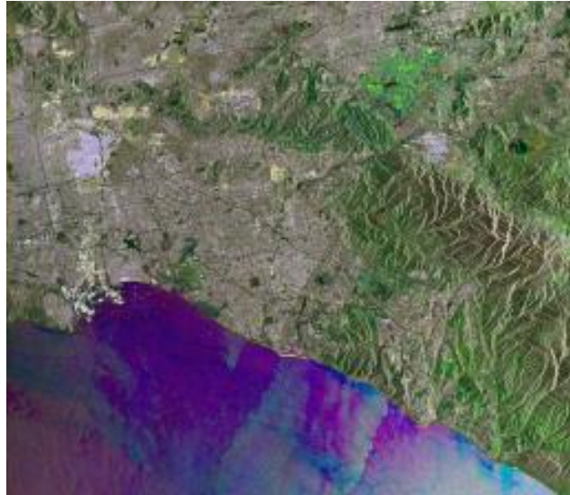
Şekil 3.29 Çok zamanlı ASAR görüntülerden oluşturulmuş renkli radar görüntüsü, (Kırmızı:23/08/03, Yeşil:01/11/03, Mavi:05/04/03)
