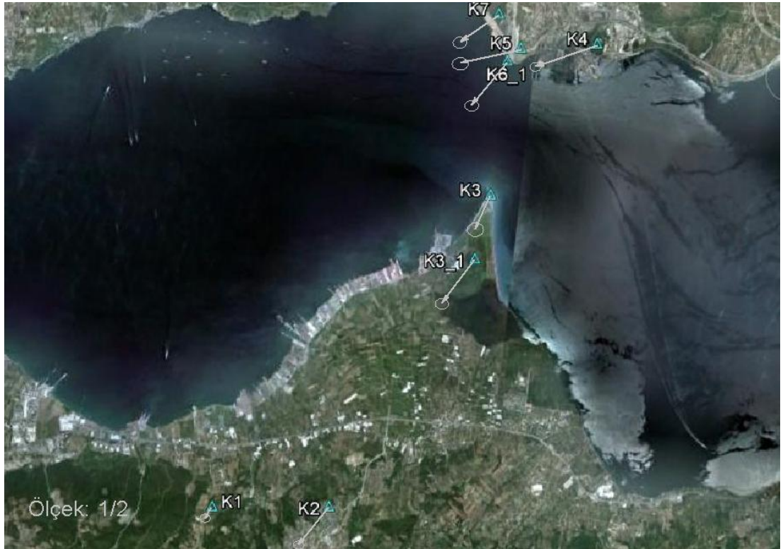
Şekil 5.10 : Deformasyon ağına ait noktalarının 1. ve 2. periyot fark vektörleri ve hata elipsleri.
