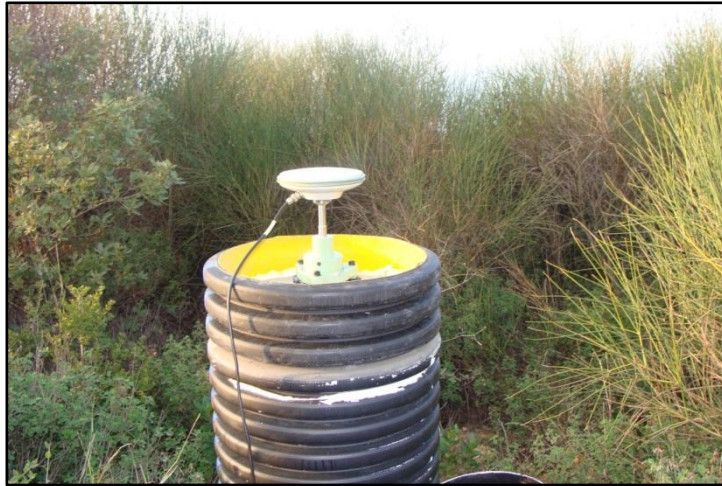
Şekil 5.5 : Deformasyon noktalarının pilye tesisi.
