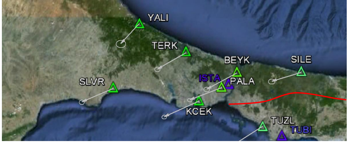
Şekil 5.9 : ISKI- UKBS ağı noktalarının 1. ve 2. periyot fark vektörleri ve hata elipsleri.
