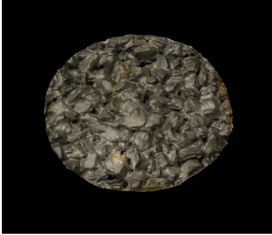
Şekil 4.37 : Asfalt Numunesine Ait Yüzey Modeli.
