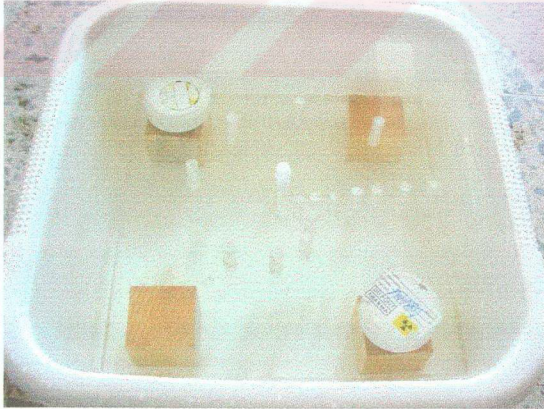
Şekil 4.19 Su İçinde 5 cm Derinlikte Yapılan Deney İçin Çekim Düzeni Görüntüsü
