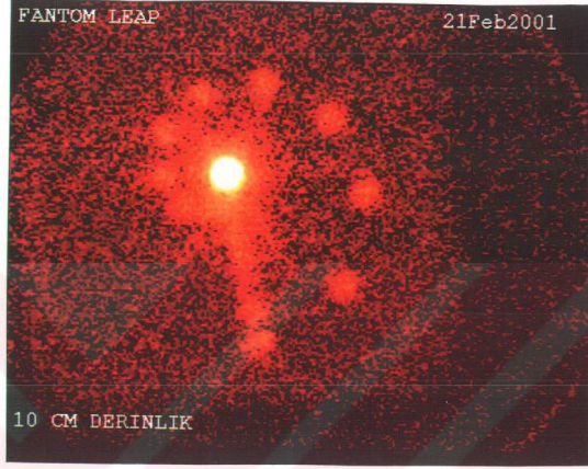
Şekil 5.3 LEAP Kolimatör ile Fantomun 10 cm Derinlikte Alınan Sintigrafik Görüntüsü
