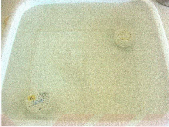
Şekil 4.20 Su İçinde 10 cm Derinlikte Yapılan Deney İçin Çekim Düzeni Görüntüsü
