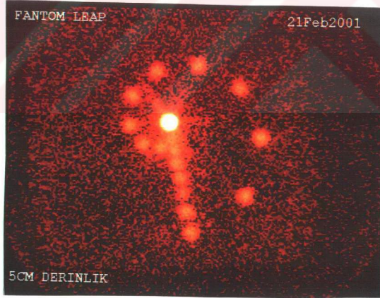
Şekil 5.2 LEAP Kolimatör ile Fantomun 5 cm Derinlikte Alınan Sintigrafik Görüntüsü
