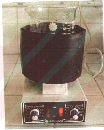
Şekil 4.14. Serbest Girdap (Vorteks) Hareketine İlişkin Akış Görünürlleştirme Deneyinin Yapılışı
