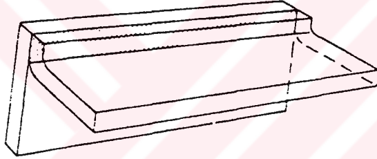
Şekil 3.7 Kenar Birleştirme Prensip Şeması (CGSB, 1981)
