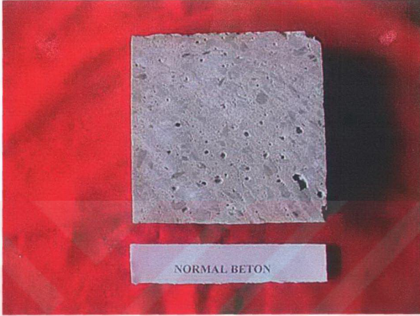
Şekil 5.3. Yüksek Yoğunluklu Normal Beton Numunesi
