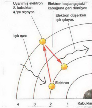
Şekil 2.2 Karakteristik X-Işınlarının Oluşum Mekanizması
