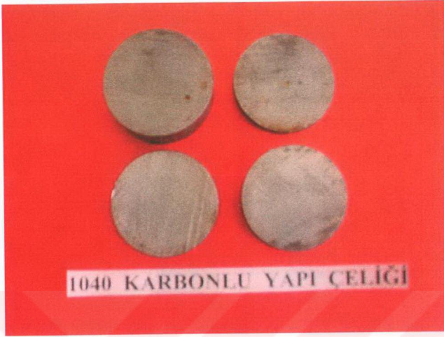
Şekil 4.3 1040 Karbonlu Yapı Çeliği Numuneleri
