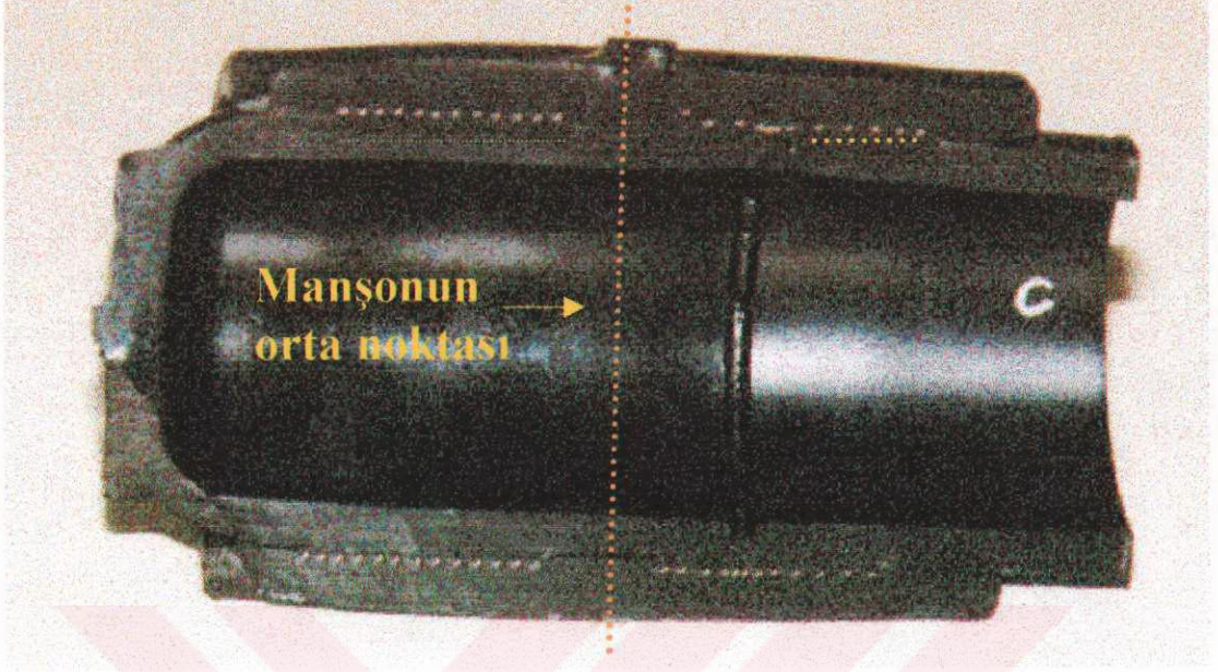
Şekil 5.18: Boruların manşon içerisine yanlış yerleştirilmesi .
