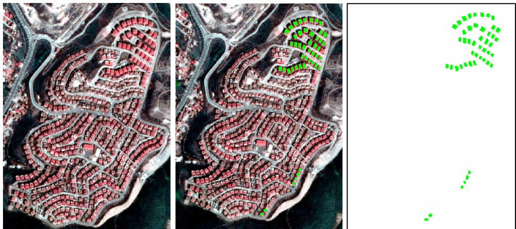
Şekil 5.3: Uzaktan Algılama ile binaların tespiti. [27]
