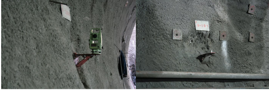
Şekil 9.1 : Tünel içi kontrol noktaları [38]
