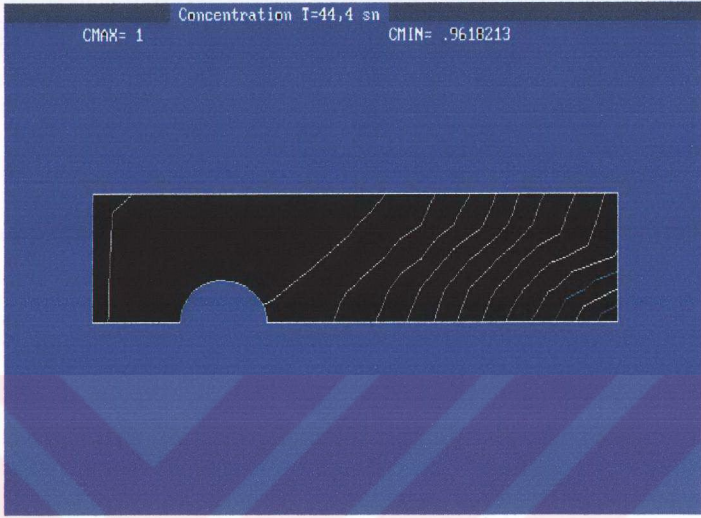
Şekil 5.13. Silindir etrafındaki zamana bağlı konsantrasyon dağılımı
