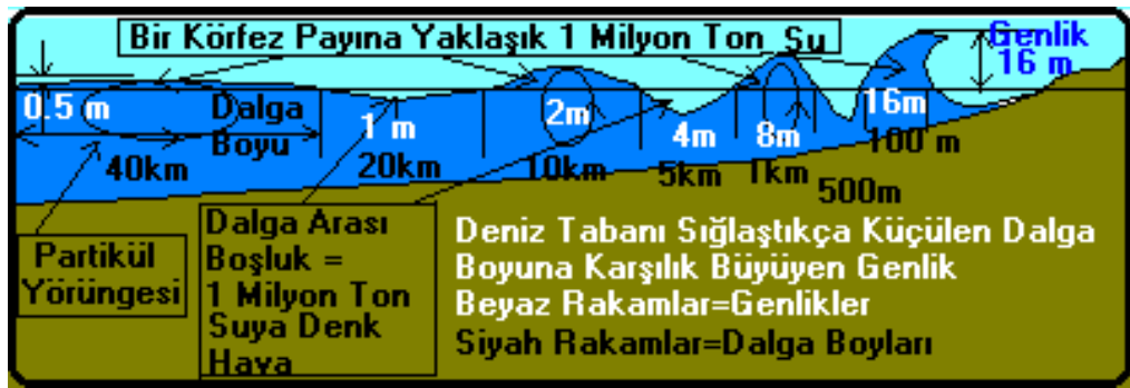
Şekil 6.3 : Tsunami Dalgasında Sığlaşma Etkisi
