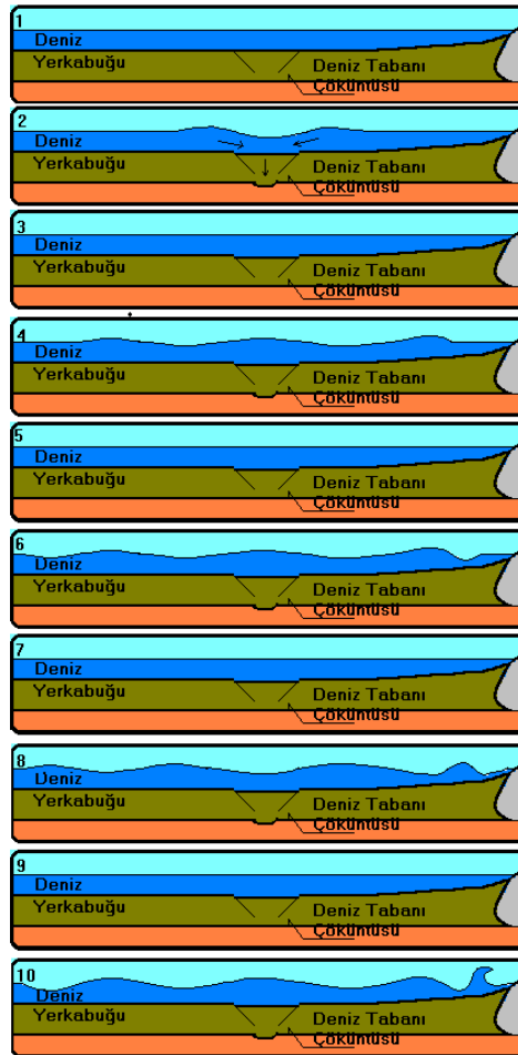
Şekil 6.1 : Deprem Sonucu Tsunami Oluşumu
