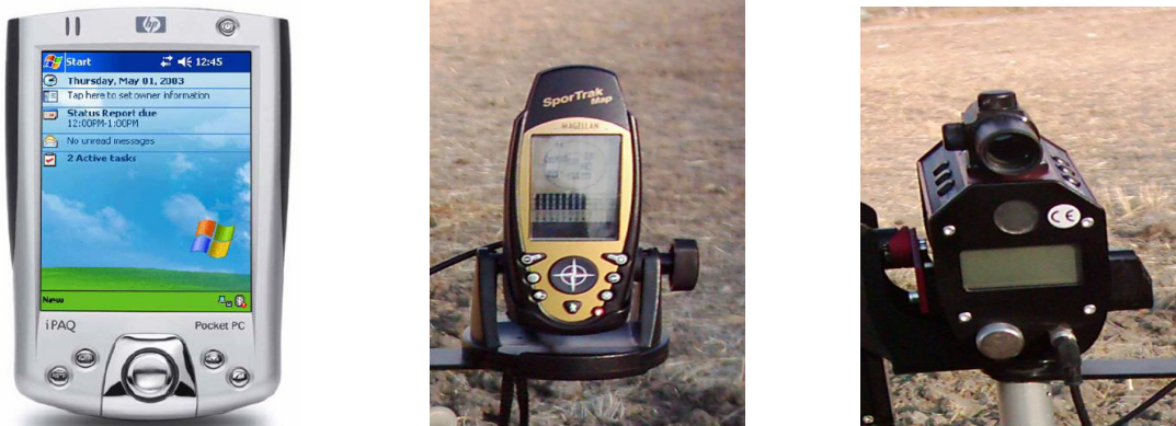
Şekil 5.15: Sayısal Sistemde El Bilgisayarı, GPS ve Lazer Mesafe Ölçer
