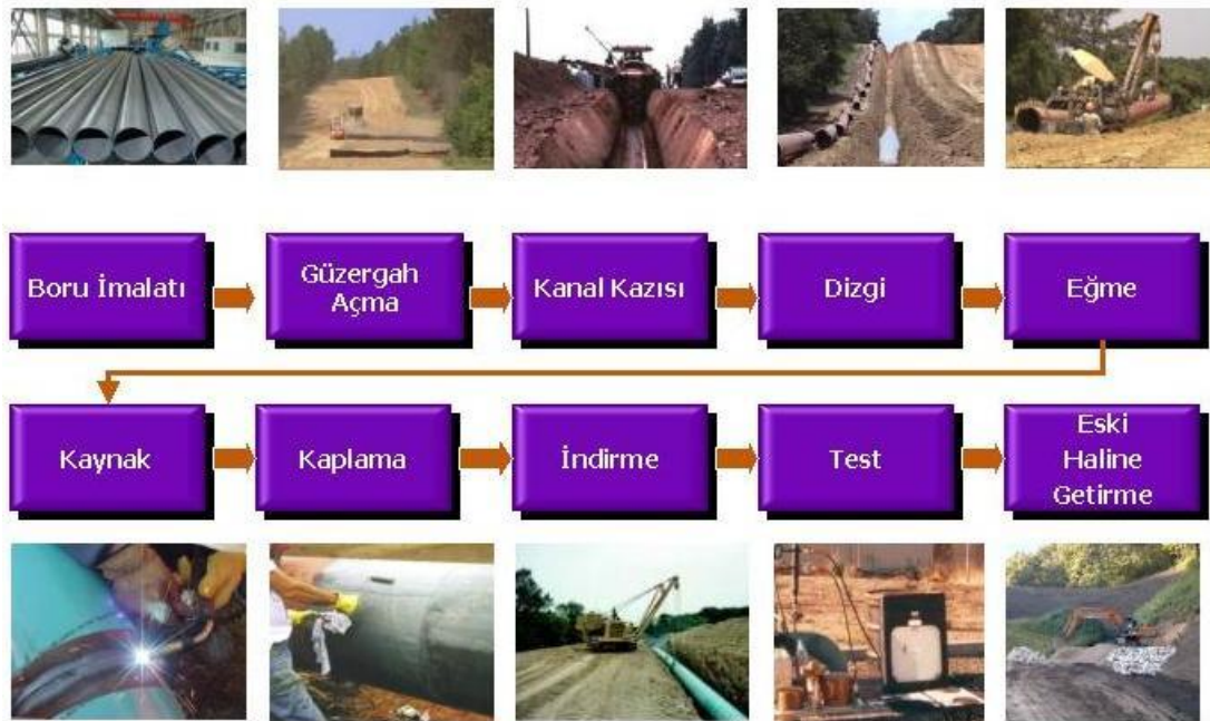
Şekil 3.2 : Boru hattı projesi yapım süreci.
