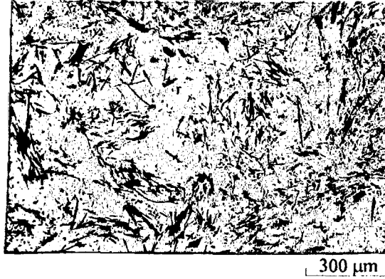
Şekil 4-4: 2.0 MPa basınçta % 15 fiber takviyeli MMK' de fiberlerarası poroziteler.
