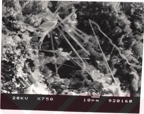
ŞEKİL: 8.27. 1400°C'de 50 L/Saat Azot Akışında Dört Saat Nütrürlenme Sonucu SEM Fotografı
