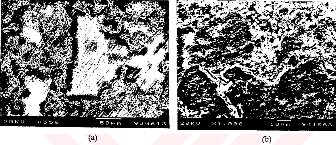
Şekil 4.12. 1000° C'da 5 saat Kalsine Edilmiş, Şekillendirme Basıncı 23 kg/mm 2 olan ve 1100° C' da 3 saat Sinterlenmiş Konsantre Numunenin Mikroyapısı. a. Genel görünüm, b. Agregalar ve sınır bölgeleri.
