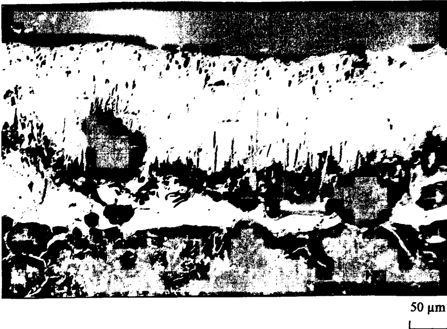
Şekil 5.4 950°C sıcaklıkta 6 saat süre ile borlanmış A serisi KGDD'in mikroyapısı
