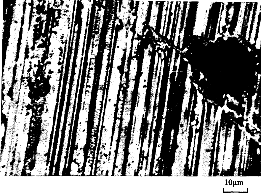
Şekil 5.98 950°C sıcaklıkta 6 saat süre ile korlanan C serisi numuneye 2N yük altında uygulanan aşınma deneyi sonucunda oluşan izin mikroyapı görüntüsü
