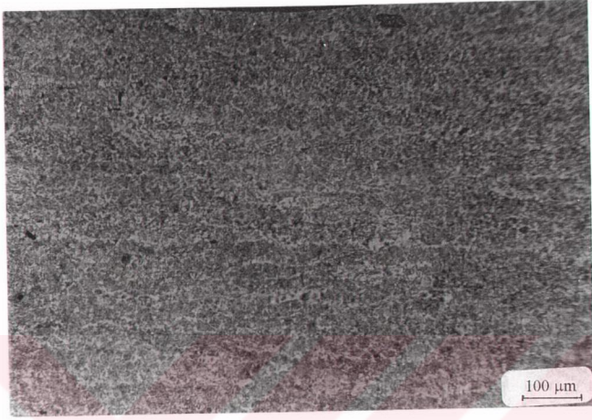
Şekil 5.35 Küreleştirilmiş AISI 5140 çeliğinin hadde yönüne paralel mikroyapısı (Ferrit + Küreleşmiş karbonlar). Dağlama %3 nital. ( \times 100 ).
