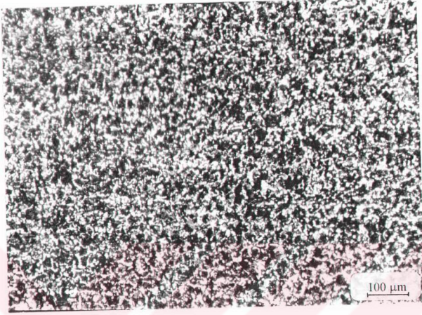
Şekil 5.33 Normalize edilmiş AISI 5140 çeliğinin hadde yönüne paralel mikroyapısı (Ferrit + Perlit). Dağlama %3 nital. ( x 100 )
