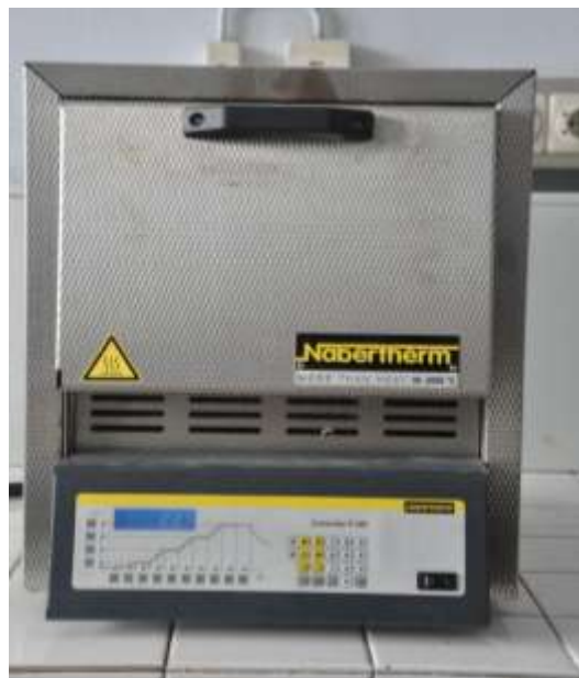
Şekil 3.6 : Nabertherm ısıtım fırını.
