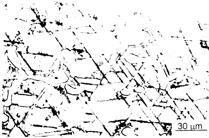
Şekil 3.20. Ağ.% 0.48 Si içeren CrNiCo süperalaşımının 900 °C’de 25 saat tutma sonucu oluşan mikroyapısı . Bu mikroyapı blok R fazı ile muhtemel silisid ve laves fazlarını içermektedir (%10 CrO 3 ile dağlanmış ve 10 gr KMnO 4 + 40 ml Su ve 4 gr NaOH+ 46 ml su çözeltisi ile renklendirilmiştir).
