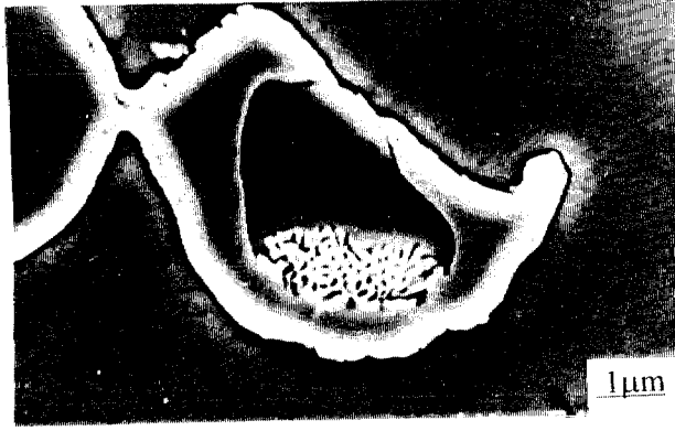
Şekil 3.6. Ağ.% 4.20 silisyum içeren alaşımin SEM mikrografı. Matriste çökelmiş blok sigma fazı içinde yerleşmiş chi ve sigma/chi arayüzeyinde M_{23}C_6 karbürü.
