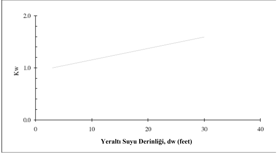
Şekil 2.7 Sıvılaşma olasılığı eşitlikleri için yer altı suyu derinlik düzeltme faktörü (FEMA, 1999)
