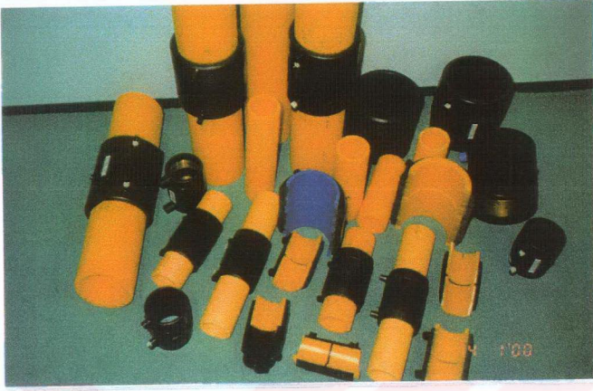
Şekil 7.6 Deneysel çalışmada kullanılan polietilen boru ve manşonlar
