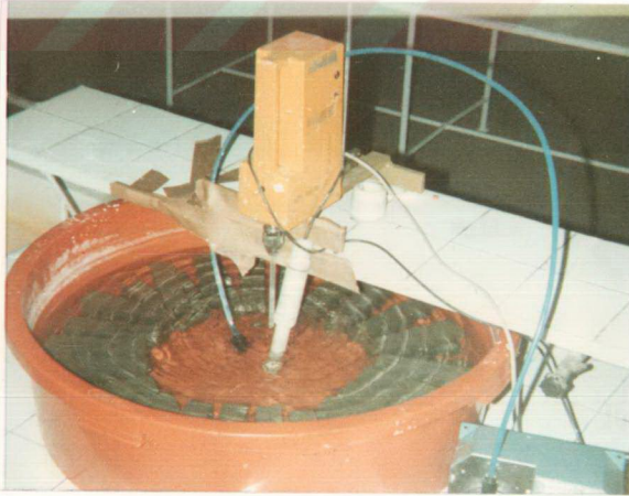
EK.2 Numunelerin \text{Na}_2\text{SO}_4 etkisinde bırakıldığı düzenek
