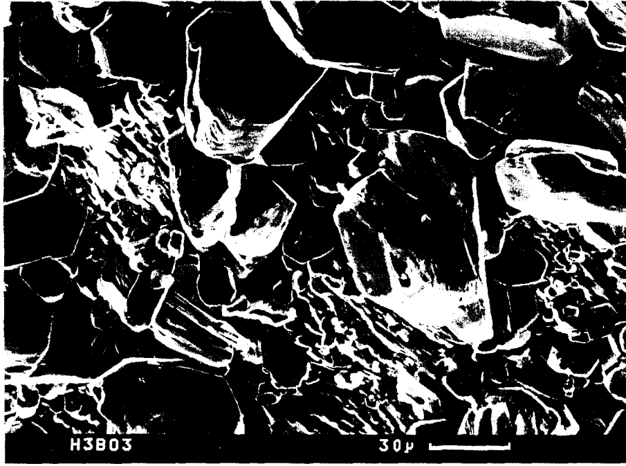
Şekil A.3 Şekil 6-10'da Verilen Akışkan Yatakta Büyütülmüş Normal Borik Asit Kristalinin Elektron Mikroskobundaki Detay Fotoğrafı
