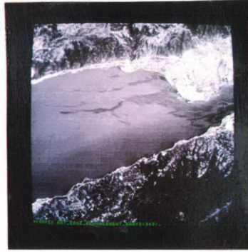
Şekil 5-12(b) : İncelenen körfez alanının kenar zenginleştiriminden sonraki görüntüsü. (Kanal 3).
