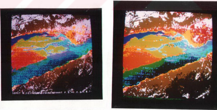
Şekil 5-18 : İncelenen bölgede tüm bantlar (Bant 6 hariç) için Lineer Diskriminant fonksiyonu ile sınıflandırma ve model zenginleştirimi.
