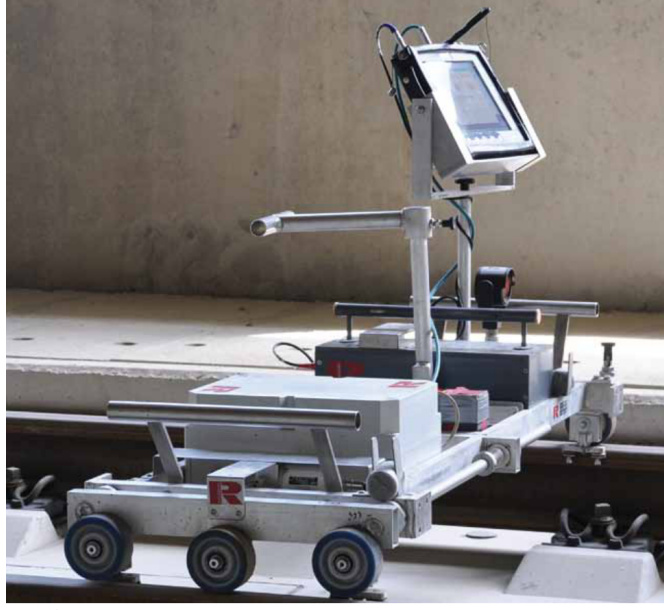
Şekil 5.7 : Rhomberg HERGIE ölçme sistemi.
