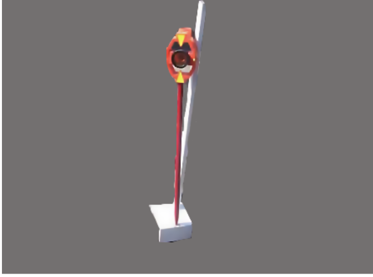
Şekil 5.9 : Reflektör ve ray ölçme aparatı.
