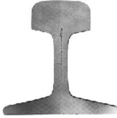
Şekil 4.6 : Boyuna dikey çatlak.
