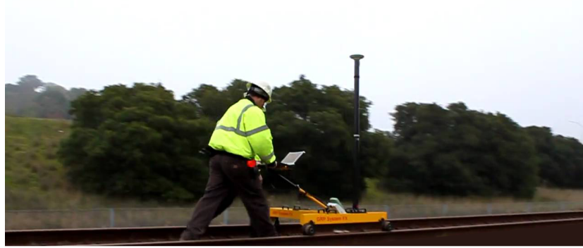
Şekil 5.11 : Sonoma-Marin Transit Ray Hattı rölöve ölçümü.
