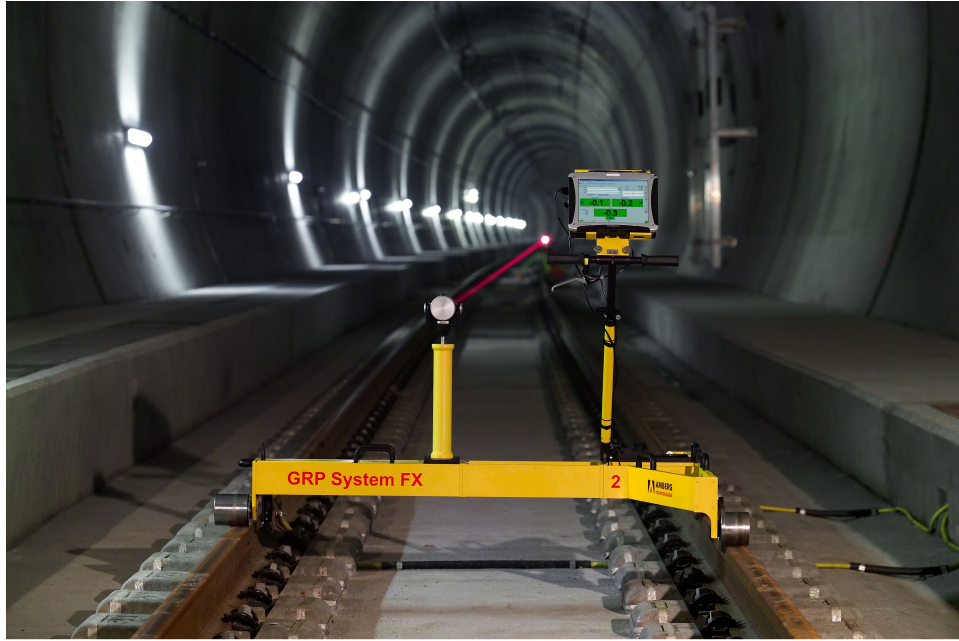
Şekil 5.1 : GRP FX ölçme sistemi.
