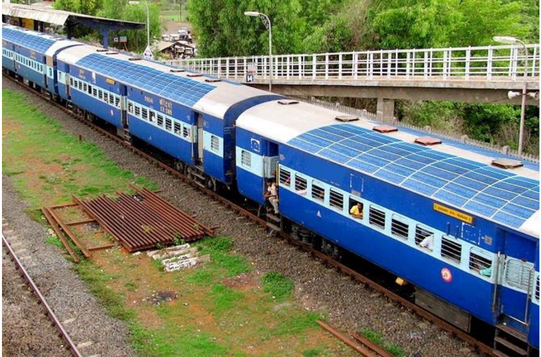
Şekil 5.4 : Güneş enerji paneli yerleştirilmiş demiryolu aracı.
