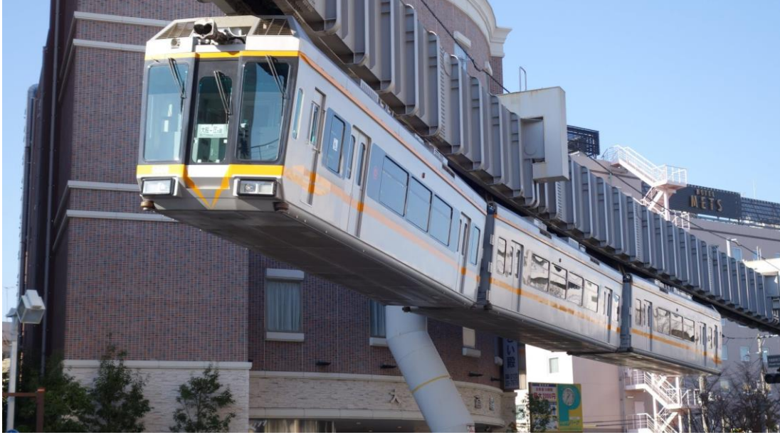
Şekil 3.1 : Askı tipi monoray örneği.
