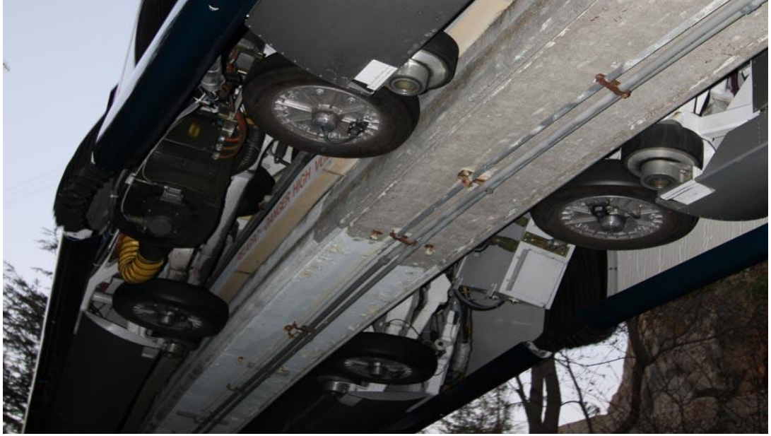
Şekil 3.2 : Bindirme tip monorayın kirişi saran tekerlekleri.
