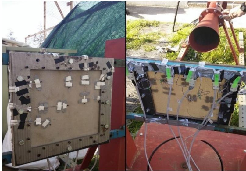
Şekil 4.30 : Basınç sensörleri(solda) ve RS232 bağlantıları(sağda).
