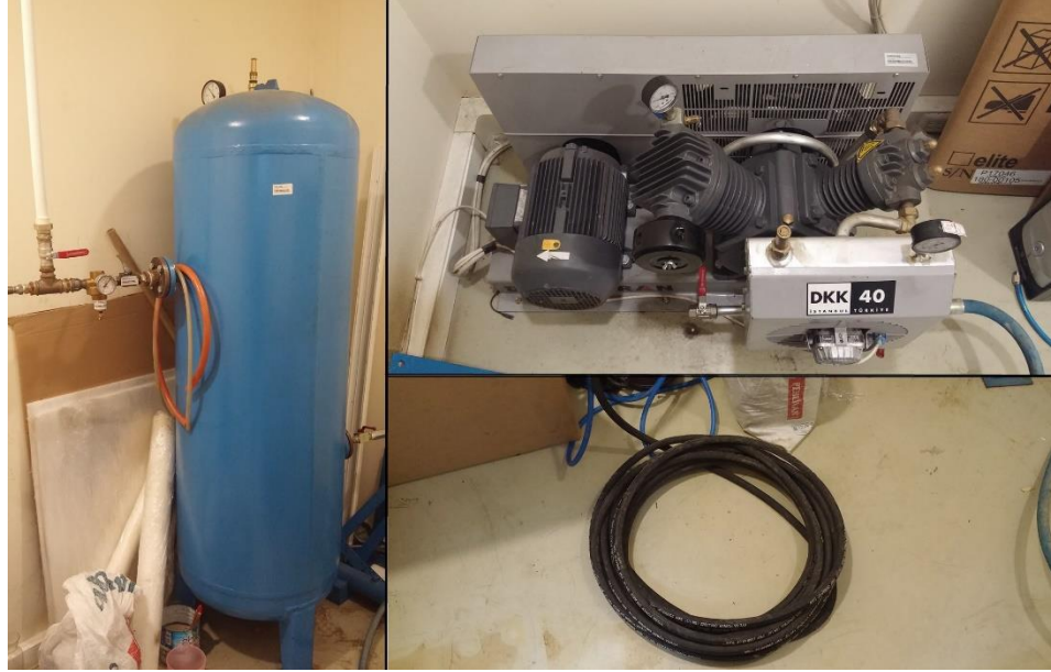
Şekil 4.2 : Basınç tankı (solda), kompresör (sağ üstte) ve Hydra Power hortum (sağ altta).
